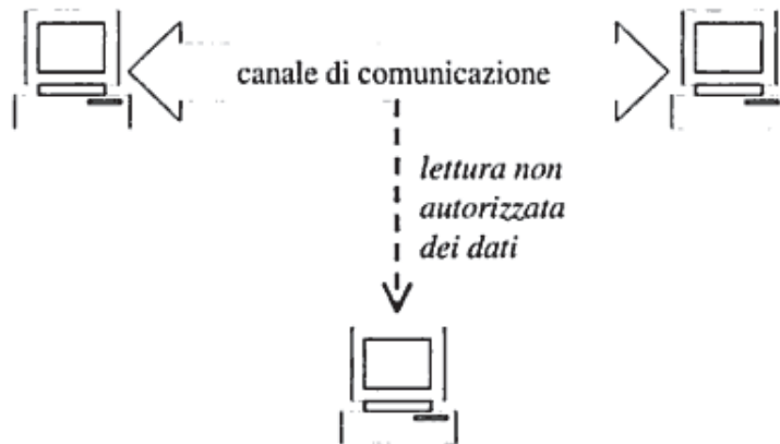
Figura 3.14: Schema funzionamento attacco di tipo Sniffing
